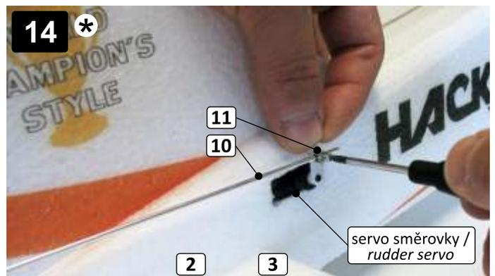
Nastavte servo a kormidlo směrovky do neutrální polohy a táhlo (10) zajistěte dotažením šroubu konektoru táhla (11) na páce serva.
