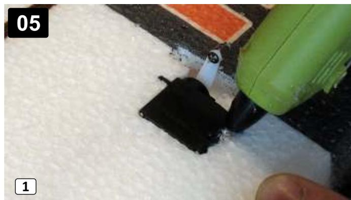
Osadte serva do křídla (1) a zajistěte je lepidlem z tavné pistole. Put the aileron servos into the wing (1) and glue them with hot glue (hot glue gun).
