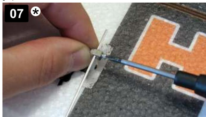
Nastavte servo a křídélko do neutrální polohy a táhlo (8) zajistěte dotažením šroubu konektoru táhla (11). Při utahování šroubku buďte opatrní abyste se neporanili.
