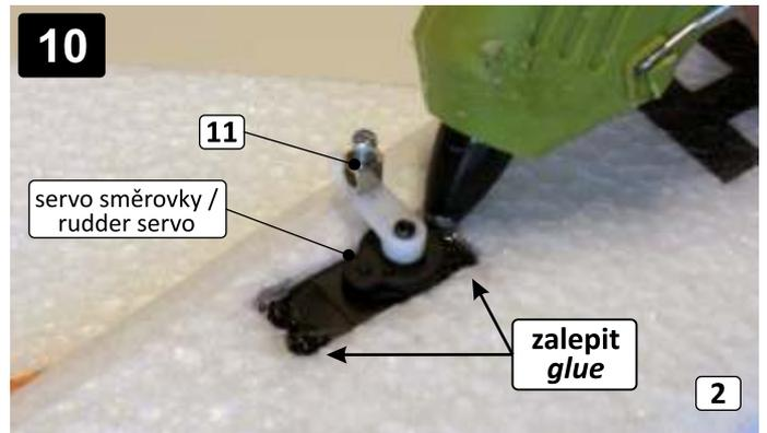
Serva směrovky a výškovky zasuňte do trupu (2) a zalepte je lepidlem z tavné pistole tak, aby konektor táhla (11) při pohybu páky nenarážel do trupu.
