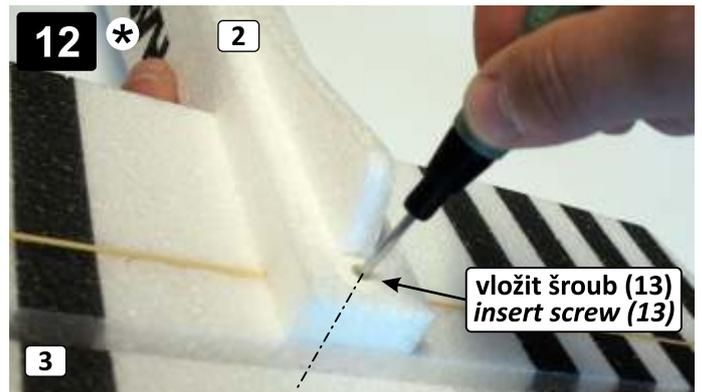
Do plastové zdičky na spodní části trupu vložte šroub M3 (13) a zašroubujte jej. Výškovku k trupu nelepte, může zůstat odnímatelná.
