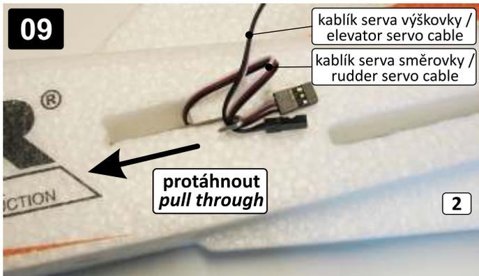
Protáhněte kablíky serv směrovky a výškovky otvorem v trupu (2). Použijte třeba delší drát s háčkem na konci nebo provázek.
