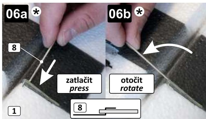
Osadte táhla křidélek (8). Zasuňte táhlo Z ohybem do otvoru v páce křidéleka. Carefully spin and apply light pressure to get the z-bend in the aileron control horn.
