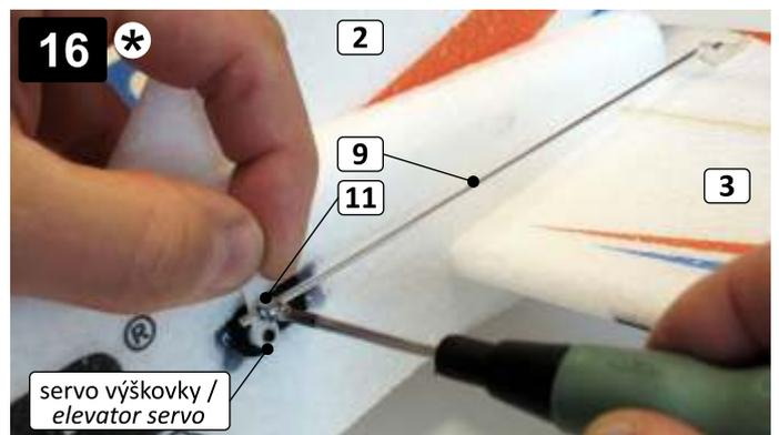
Nastavte servo a kormidlo směrovky do neutrální polohy a táhlo (9) zajistěte dotažením šroubu konektoru táhla (11) na páce serva.
