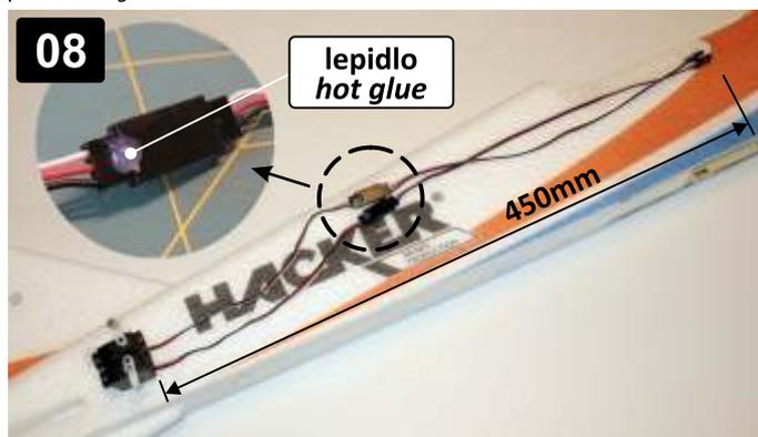
Připravte si serva směrovky a výškovky. Zkontrolujte délku kabelů serv a případně je prodlužte na délku cca 45cm. Spoj konektorů zajistěte malým množstvím tavného lepidla proti rozpojení.
