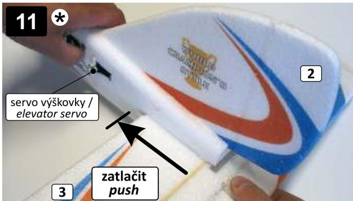
Do trupu (2) upevněte výškovku (3). Vložte ji do otvoru v trupu.
