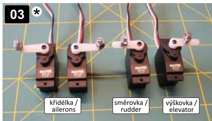
Serva nastavte do neutrálních poloh a připevněte na ně páky dle obrázku. Set servos to the neutral position and attach servo-arms. Don't forget to use screws.
