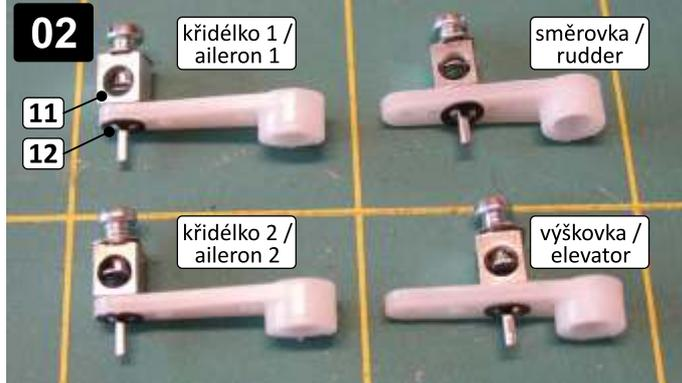
Připravte si páky serv. Na páky upevněte konektory táhel (11). Konektory umístěte do otvorů dle diagramu na straně 4 a proti vysunutí je zajistěte pojistkou quicklock (12).
