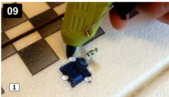
09 Serva do křídla (1) zalepte malým množstvím lepidla z tavné pistole. Glue the servos into the wing (1) with hot glue (hot glue gun).
