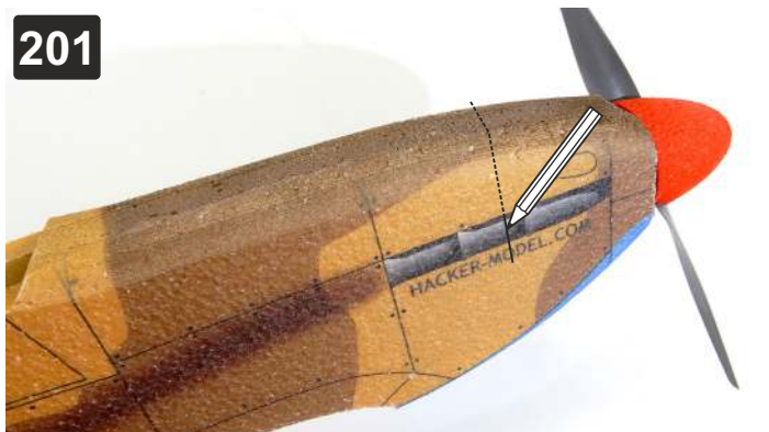
baterii umístěte tak, abyste model vyvážili / place battery according to get right position of C.G.
