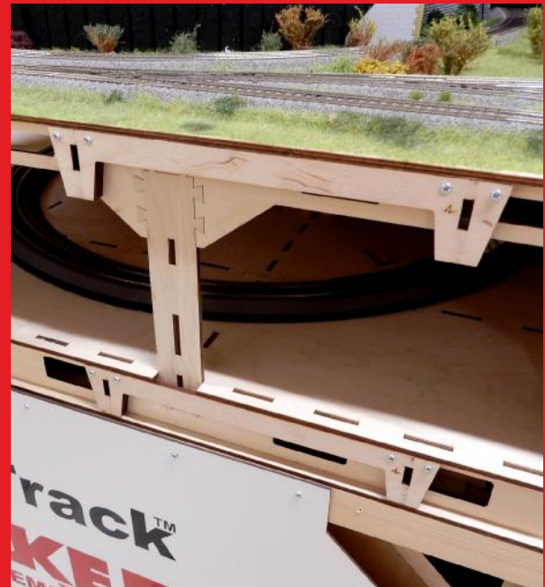
Základní deska se skrytým nádražím Basisplatte mit Schattenbahnhof Baseboard with hidden station
